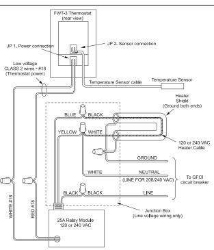
FWT-3 Wiring Diagram
